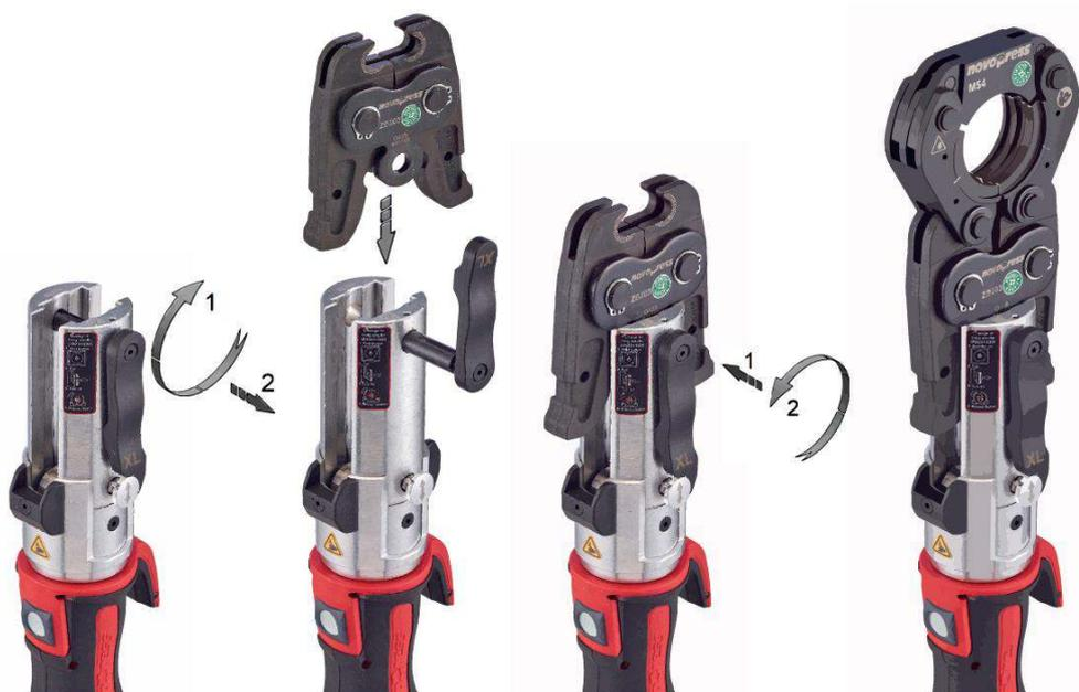
Les crampons de l'adaptateur doivent mordre autour des goujons de la mâchoire circulaire. Les repères sur les crampons doivent être complètement couverts après le positionnement de la mâchoire. Si un repère est partiellement visible, l'adaptateur doit être repositionné.
