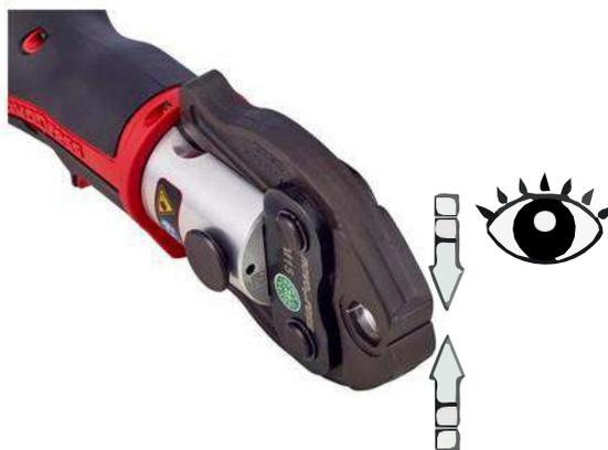
**Note :** si le bouton est relâché avant le début du cycle, le piston retourne à sa position initiale. Le sertissage n'a pas été effectué, il est nécessaire de déclencher à nouveau le processus.
