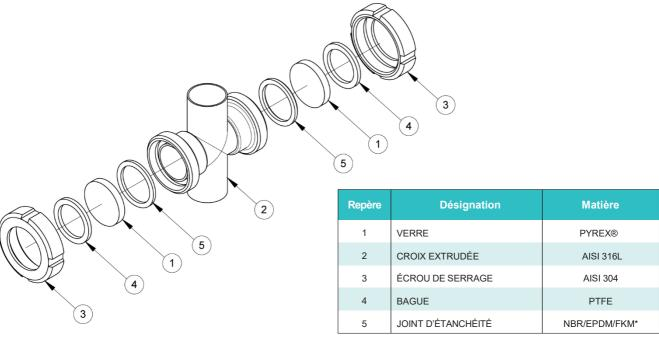
\*Joint NBR en standard (EPDM ou FKM sur demande)
