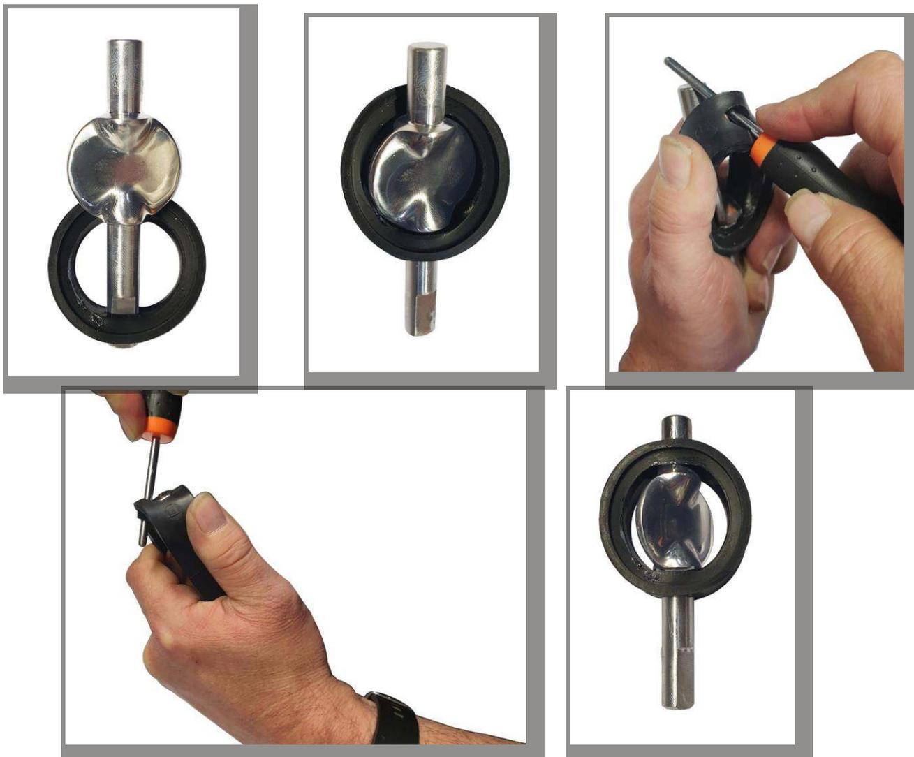
A partir del DN63, la junta puede deformarse manualmente sin herramientas.
