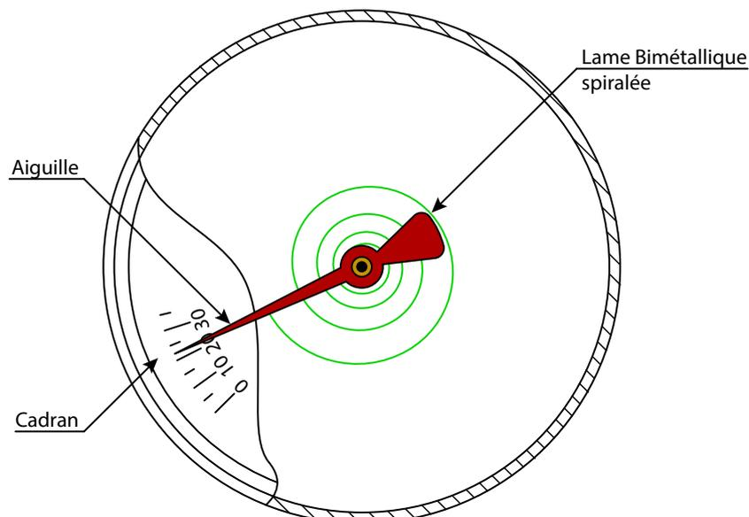
Reliée à l'aiguille par une broche, la déformation du système bimétallique entraîne la rotation de la broche et ainsi la rotation de l'aiguille.
