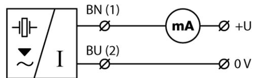
Connecter la phase d'alimentation sur la borne 1, le signal de retour se fera par mesure de l'intensité (en mA) sur cette même phase.
