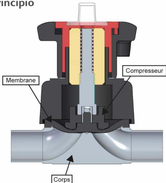
La válvula de diafragma se compone, globalmente, de un cuerpo de inox **1**, una o varias membranas **2** y un actuador **3** que incluye un compresor.
