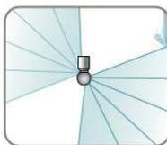
Les têtes de lavage à rotation libre fonctionnent avec des buses de pulvérisation positionnées de manière à ce que le fluide entraîne la tête pour tourner. Elles sont particulièrement adaptées aux réservoirs de taille petite à moyenne. Nous proposons plusieurs modèles. Les modèles 8081 et 8091, de classe de lavage 2, s'utilisent sur des substances peu visqueuses. Le modèle 8082 de classe 3 a des jets améliorés pour nettoyer des fluides plus visqueux.
