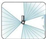
Les têtes à rotation contrôlée sont entraînées par le fluide avec en plus, un système mécanique qui permet de contrôler la rotation. Cela garantit une vitesse constante et optimale même avec des variations de pression. Elles sont particulièrement adaptées aux réservoirs de taille moyenne à grande. Notre modèle 8083 de classe de lavage 4 est adapté aux substances visqueuses.
