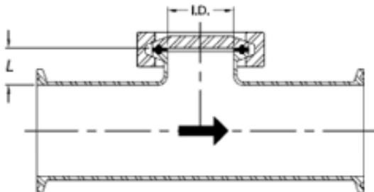
Un bras mort est donc une zone de rétention qui favorise le développement de micro-organismes et contamine l'installation. Pour empêcher ce phénomène, il a été prouvé que le rapport L/D doit être inférieur ou égal à 2. Dans l'industrie pharmaceutique il est donc recommandé d'éviter ou de minimiser les bras morts.
