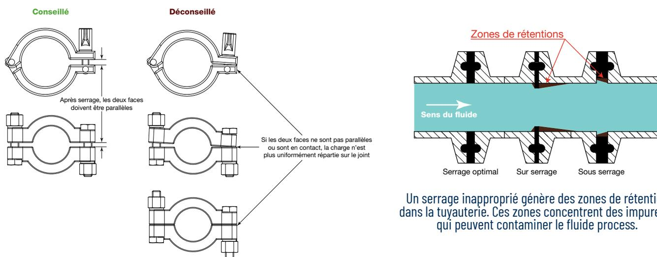
Un joint est plus ou moins comprimé selon le couple de serrage appliqué au collier. Chaque joint a un taux de compression qui lui est propre suivant sa matière et sa dimension. Il est possible de déterminer le couple à appliquer selon ses caractéristiques pour être sûr de répondre aux exigences de l'ASME BPE et éviter la formation de bactéries.
