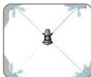
Les buses sont positionnées sur une roue ce qui permet d'avoir une double rotation contrôlée. Les jets qui en résultent sont puissants et balaient toute la surface du réservoir selon un modèle prédéfini et un temps minimal. Ces têtes de classe de lavage 5 restent la solution la plus efficace dans le cas de récurage de très grandes cuves ou de cuves avec un degré de salissure élevé (modèle 8084).
